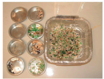
Éléments exogènes présents dans un compost après tri et séchage par la méthode des inertes.
